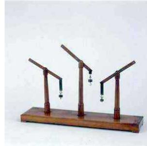
Viceversa, quando il braccio di leva della forza motrice è più corto, l'equilibrio si ottiene mediante l'applicazione di una forza superiore alla resistenza: in questo caso la leva viene detta **svantaggiosa**.
